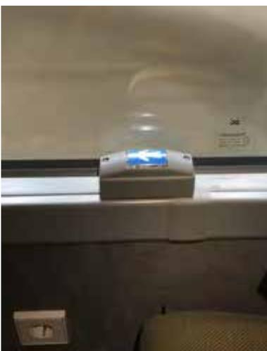
Bild 31: Kommunikationseinrichtung neben dem Sitzplatz für Fahrgäste mit eingeschränkter Mobilität
