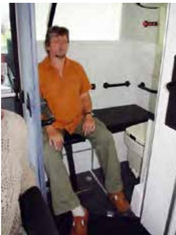
Bild 33: Beispiel für ein barrierefreies WC im Heckbereich eines Reisebusses
