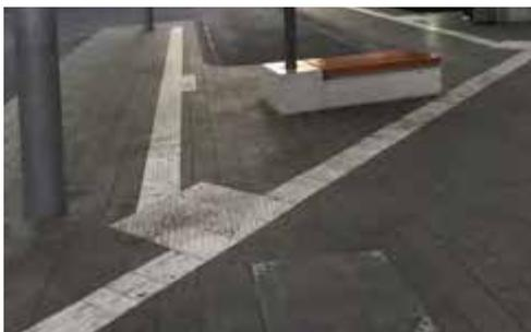
Bild 47 Bodenindikator-basiertes Leitsystem (Abzweig zur Haltestelle) – Hannover
