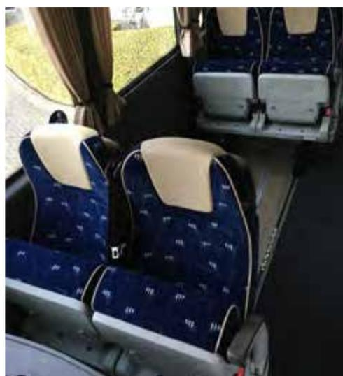
Bild 16: Zusammengeschobene Sitzreihen im Bus
