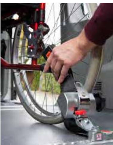
Bild 22: Verbinden des Rückhaltesystems mit dem Kraftknoten (Gurtschloss und Schlosszunge)
