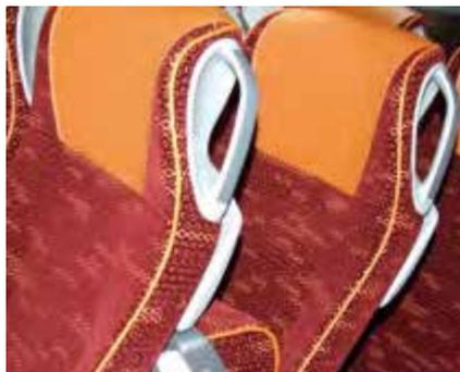
Bild 25: Visuell kontrastierende Ausführung der Handgriffe an den Fahrgastsitzen
