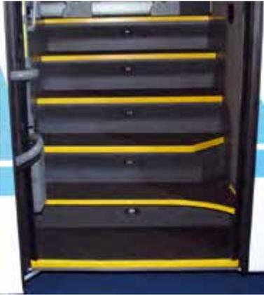
Bild 5: Einstiegsstufen mit visuell kontrastierender Stufenkantenmarkierung
