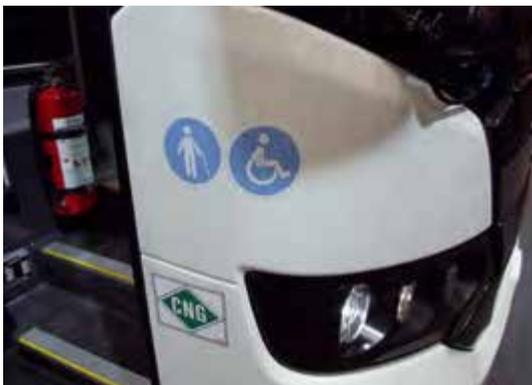
Bild 3: Kennzeichnung eines Busses an der vorderen Betriebstür mit Piktogrammen gemäß UN/ECE R 107
