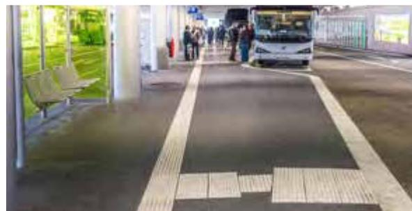
Bild 48: Einstiegsfeld (rechts) mit Anbindung an ein Bodenindikator-basiertes Leitsystem – Stuttgart
