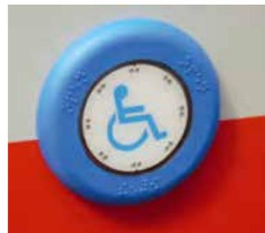
Bild 12: Kommunikationseinrichtung zur Anforderung einer Einstiegshilfe neben der Betriebstür an der Fahrzeugaußenseite
