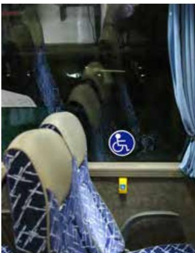
Bild 13: Rollstuhlstellplatz mit Piktogramm und Anforderungstaster (Situation mit eingebauten Fahrgastsitzen)
