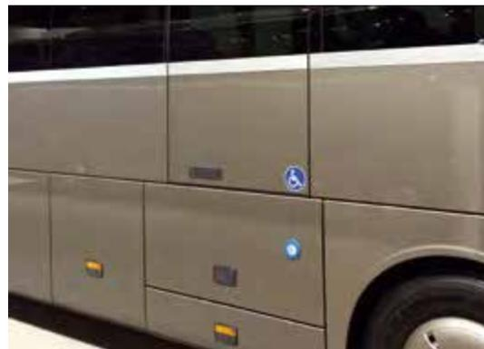
Bild 4: Kennzeichnung der Betriebstür (hier: Schlagtür) für den Zugang eines Rollstuhlfahrers mittels Piktogramm
