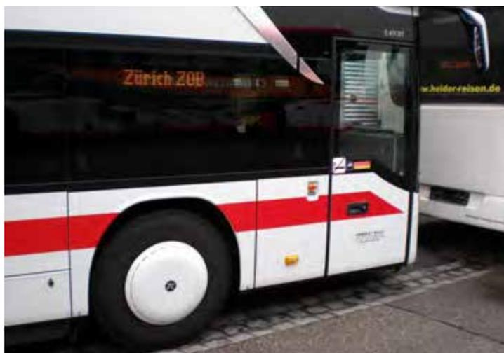
Bild 36: Fahrtzielanzeiger an der Einstiegsseite
