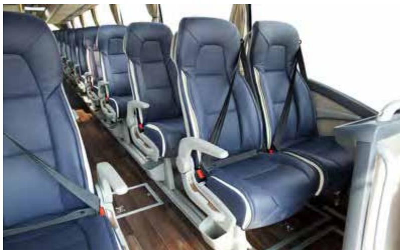
Bild 32: Fahrgastsitze mit Dreipunkt-Gurtsystem in einem Reisebus
