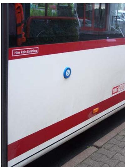
Abbildung 3: visuell kontrastierender Anforderungstaster an der Fahrzeugaußenseite
