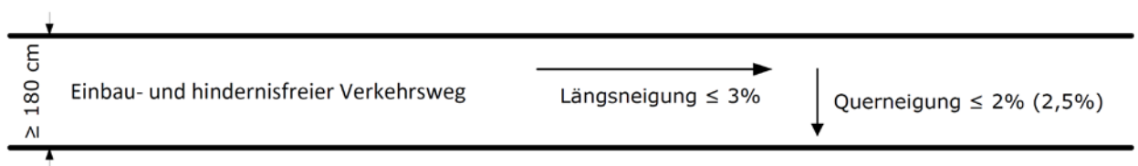
Abbildung 3: Anforderungen an einbau- und hindernisfreie Verkehrswege (Draufsicht)
