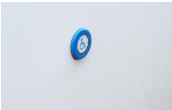
Abbildung 3: visuell kontrastierender Anforderungstaster an der Fahrzeugaußenseite
