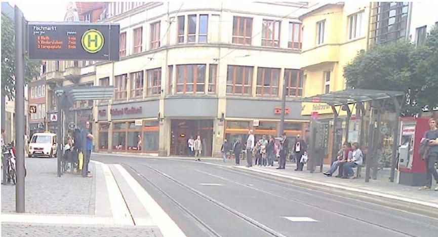
Abbildung 19: Beispiel für visuellen Kontrast zwischen Gleisbereich und Bahnsteigkante
