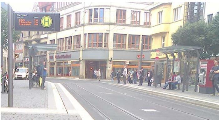
Abbildung 16: Beispiel für visuellen Kontrast zwischen Gleisbereich und Bahnsteigkante
